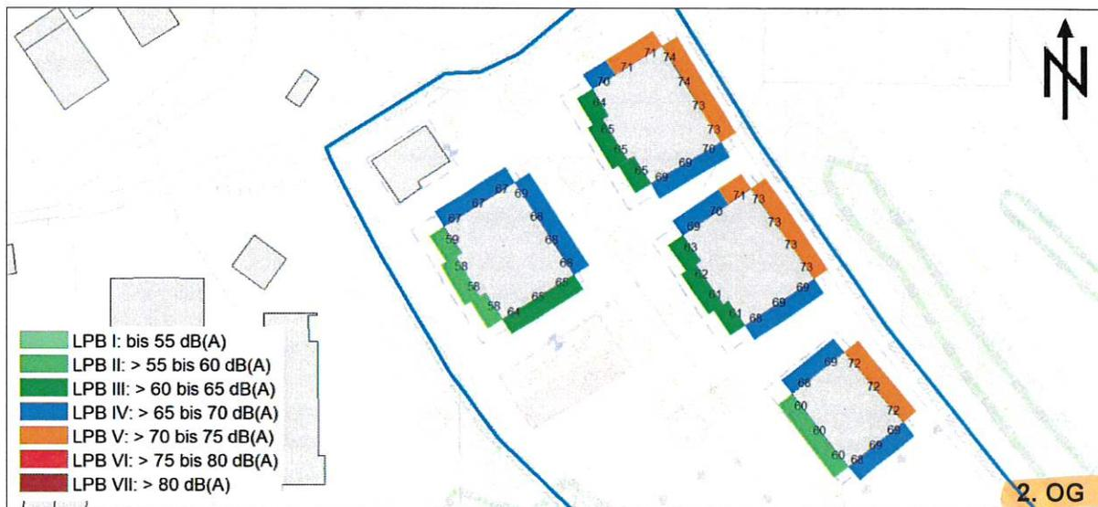
Bild 4: Baulicher Schallschutz: Maßgeblicher Außenlärmpegel und Lärmpegelbereiche DIN 4109, 2. OG
