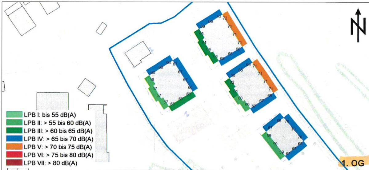
Bild 3: Baulicher Schallschutz: Maßgeblicher Außenlärmpegel und Lärmpegelbereiche DIN 4109, 1. OG
