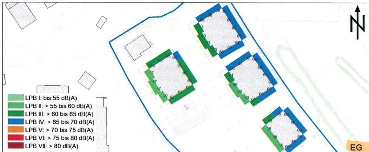
Bild 2: Baulicher Schallschutz: Maßgeblicher Außenlärmpegel und Lärmpegelbereiche DIN 4109, EG
